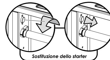
Sostituzione dello starter
